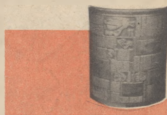
Cliché demi-cylindrique en plomb d'une page pour tirage sur rotative typo.
